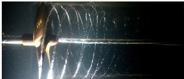
Fig. 8: Cavitação ocorrendo em hélice subaquática
